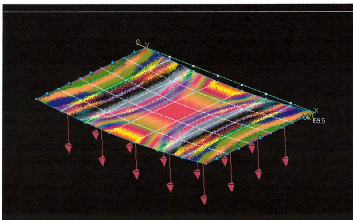
figura 2.5:Análise estática da chapa bi-apoiada
